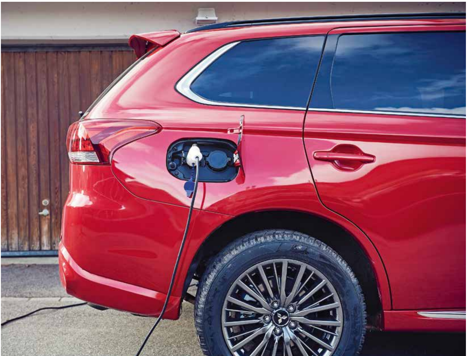
Eine Haushaltssteckdose genügt: Der Outlander PHEV fährt rund 45 Kilometer rein elektrisch.
