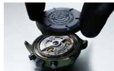
Das Uhrwerk wird ins Gehäuse eingeschalt.
