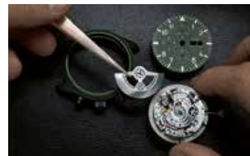
Der Rotor wird am Uhrwerk befestigt.
