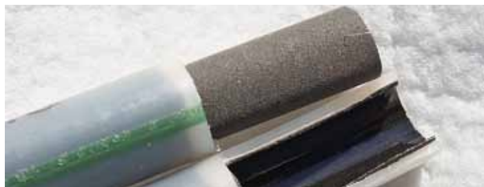
Saniertes «Rohr im Rohr».
