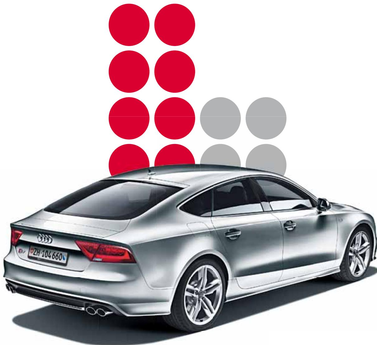
Der Audi S7 Sportback mit cylinder on demand Technologie entscheidet selbst, ob 8 oder 4 Zylinder des V8-TFSI®-Motors zum Einsatz kommen – je nach Fahrsituation. Für eine fortschrittliche Balance zwischen souveräner Performance und hoher Effizienz sorgt im Audi S7 Sportback ausserdem die besonders leichte Aluminium-Hybrid-Bauweise. Erleben Sie jetzt intelligentere Kraft auf einer Probefahrt und profitieren Sie von neuen Leasingangeboten. Jetzt bei Ihrem Audi Händler.
