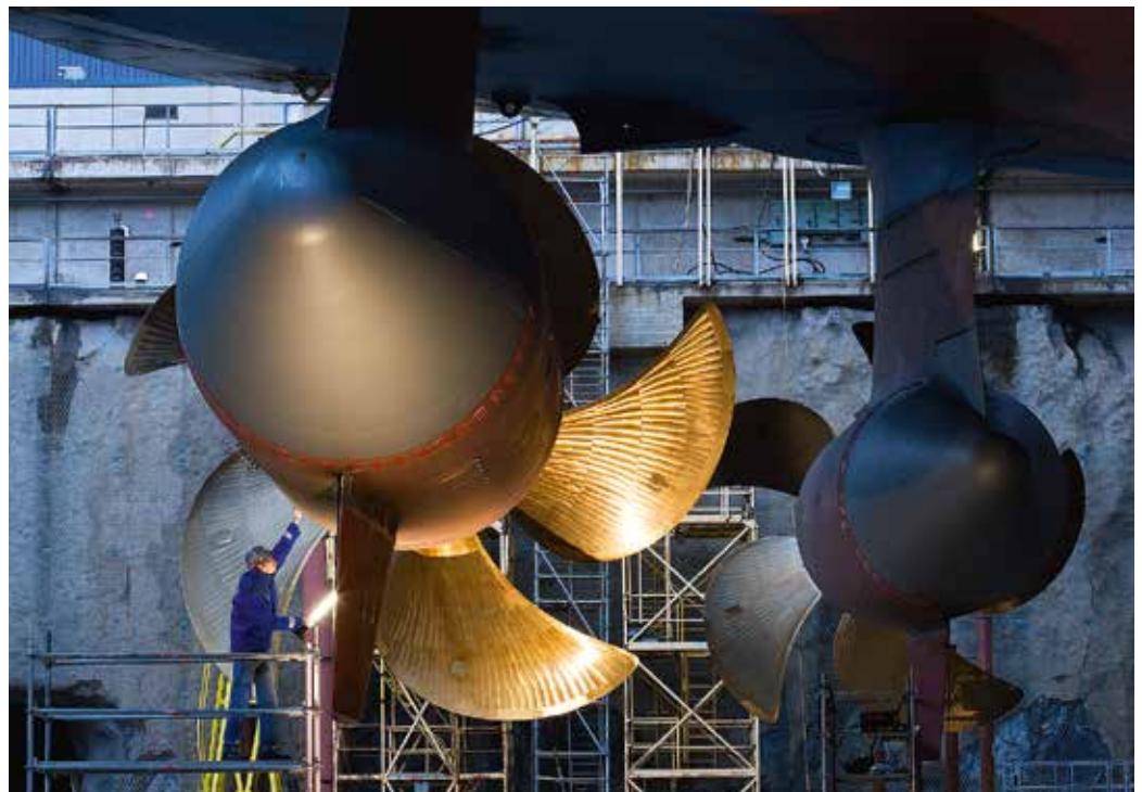
Pionierleistung: Azipod-Propellergondel des Kreuzfahrtschiffs «Oasis of the Seas» von ABB.
