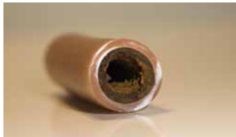
Versprödetes und verschlammtes Bodenheizungsrohr.
