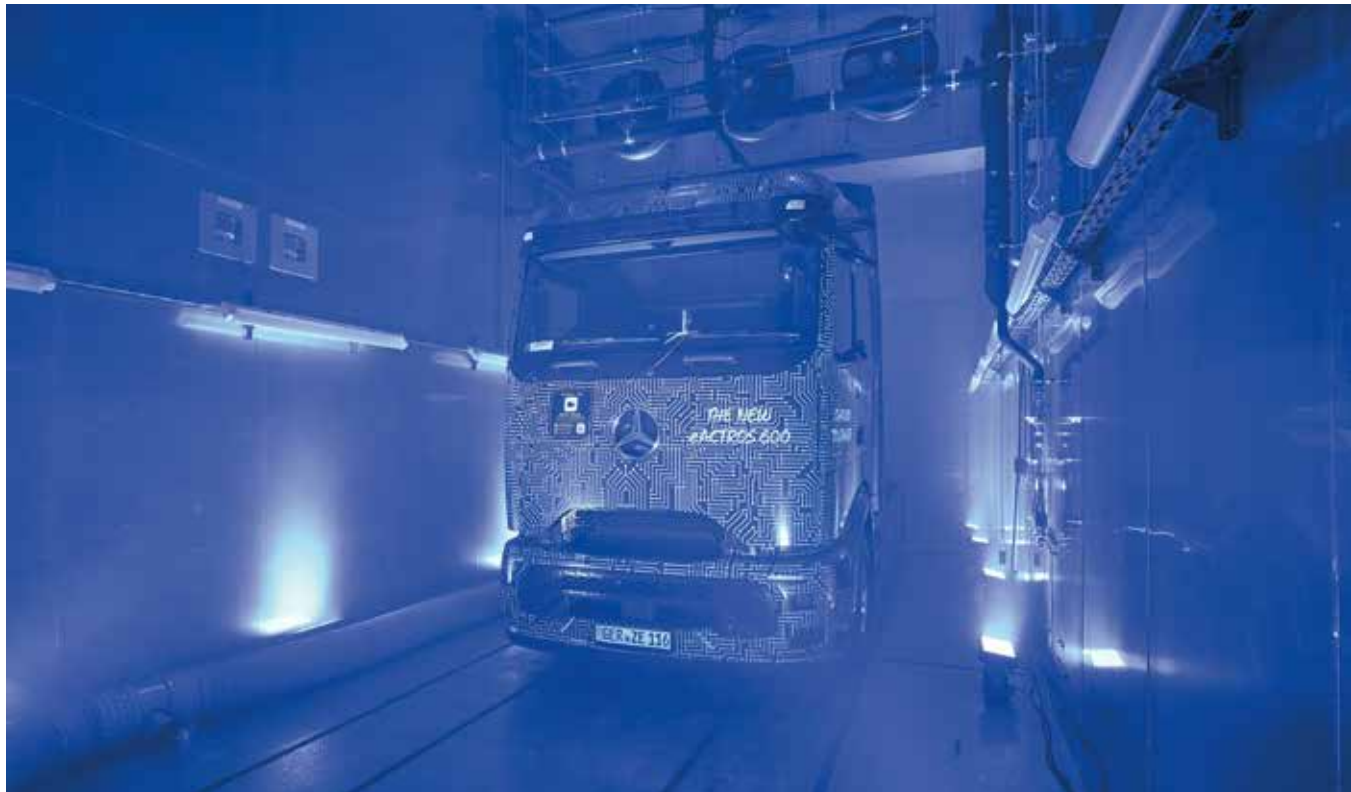
Der LKW von morgen: Der neue elektrische Actros 600 wird in der Klimawechselkammer von Daimler Trucks getestet.
