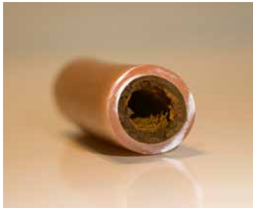
Das Hauptproblem alter Bodenheizungen: verschlammtes, versprödertes Kunststoffrohr.
